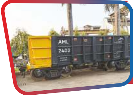
Gondola Wagon (Liberia) for Iron Ore
