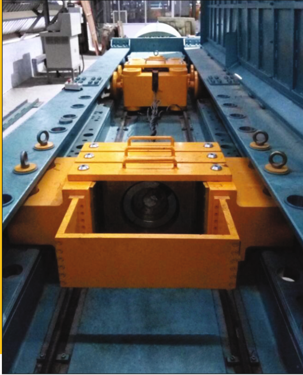
500 Ton Testing Bed
