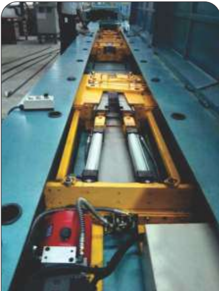
100 Ton Testing Bed
