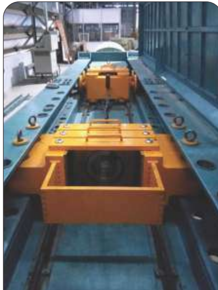
500 Ton Testing Bed
